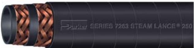
Diseñado para aplicaciones de vapor saturado a presión de 250 PSI y temperaturas a 208 °C. Esta manguera también puede manejar super calentamiento de vapor a 250 PSI y 233 °C. trenzas de alambre de acero dan máxima resistencia y se puede utilizar como un cable para hacer que el montaje de la manguera sea conductora de electricidad. Se pueden hacer crimpados permanentes.
